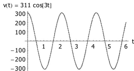
la forma d'onda della corrente a regime<sup>6</sup> sarebbe, matematicamente o nell'ipotesi che il generatore sia in grado di erogare tutta la corrente calcolata:
