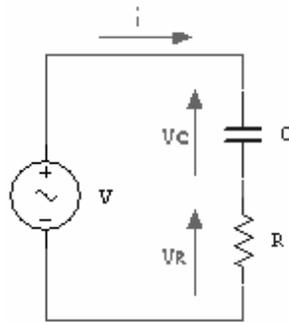
Nel circuito RC si combinano i due effetti della resistenza del resistore  $R$  e della reattanza capacitiva<sup>8</sup> del condensatore  $C$ , per cui si ha uno sfasamento complessivo tra tensione e corrente che dipende da  $R$  e da  $Z_C$ . L'impedenza totale, vettore e modulo, vista dal generatore vale (i due componenti sono in serie e quindi le loro impedenze si sommano):
