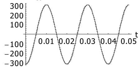
Si definisce valore efficace di una grandezza elettrica sinusoidale il valore equivalente che produce gli stessi effetti di riscaldamento della medesima grandezza continua; è quindi legato alla potenza che tale grandezza è in grado di trasferire ad un carico resistivo. Ovvero: una tensione continua (ad esempio pari a 220 V) che alimenti un dato resistore produce effetti di riscaldamento equivalenti ad una tensione alternata di medesimo valore efficace (220 V) che alimenti lo stesso componente.
